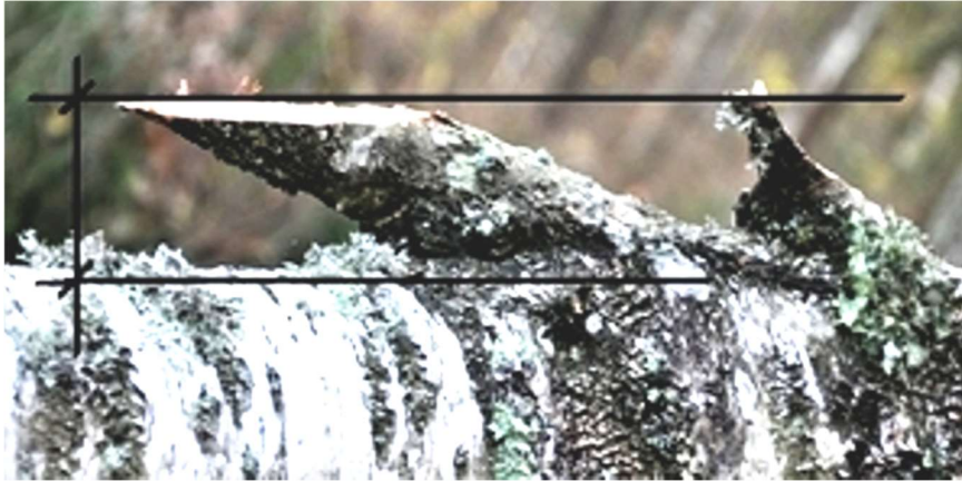
Joonis 1. Oksatüüka kõrguse mõõtmine.
