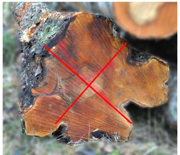
Joonis 8. Suure sajarate sügavusega sagartüüakus kuulub töötlemist (koorimist) takistavate rikete hulka.
