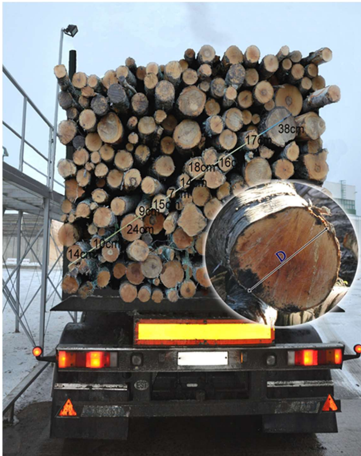
Joonis 12. Koormapaki keskmise diameetri määramine. Nottide valiku juhuslikkuse tagamiseks on koormapakile tõmmatud mõtteline joon, mis läbib vähemalt 10 notti.
