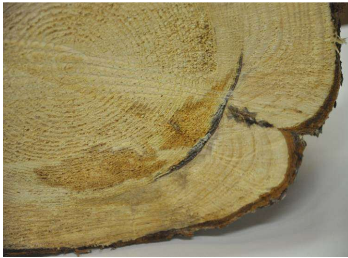
Joonis 14. Kinnine mõlu kuuse noti otspinnal. Kunagise vigastuse alla on tekkinud mädanik.
