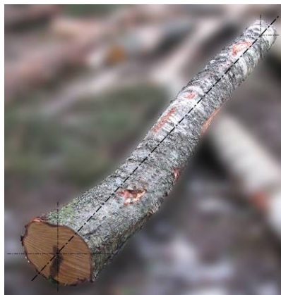
Joonis 8. Liitkõver e mitmesuunalise kõverusega kase nott.
