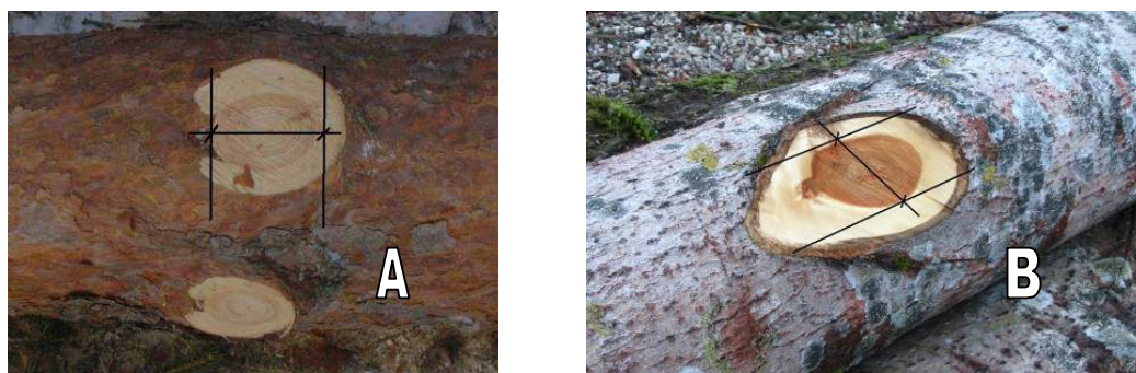
Joonis 1. Oksa diameetri mõõtmine. A- okaspuupalk; B- lehtpuupalk.
