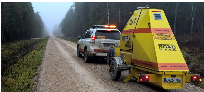
Foto 35. Metsatee kandevõimemõõtmine FWD-seadmega (kuigi mõõtja on Soomest, on foto tehtud Eestis). Foto: Sven Sillamäe.
