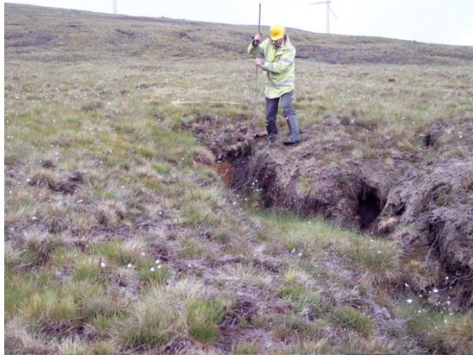
Joonis 2.23. Turba paksuse mõõtmine sondeerimisega [33]
