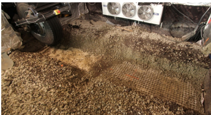
Foto 12. Tallinna Tehnikakõrgkooli teekonstruktsioonide laboris läbi viidud täismõõduline koormuskatsetus, millesse oli kaasatud ka mittekoatud geotekstiil (vasakul) ja geovõrk (paremal). Foto: Sven Sillamäe.
