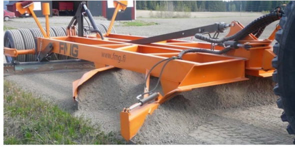
Foto 28. Traktori järgi haagitav kerge seade, millega tehakse tasandushööveldamist. Foto allikast [19].
