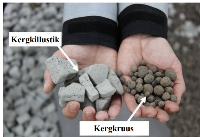
Joonis L2.1. Kergkillustik ja -kruus. [5]
