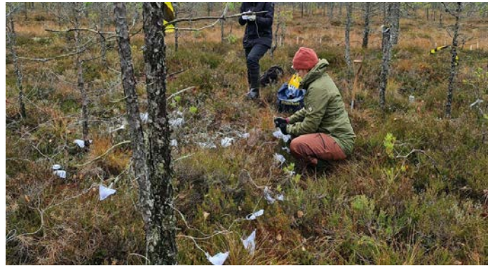
Joonis 14. Lagunemiskatse rajamine Ess-soos uurimisalal 2022. aastal. Vasakpoolsel joonisel proovide paigaldamine alale nr. 11 (kood C) pinnaspaisudega suletud kraavidega alal ning parempoolsel joonisel proovide paigaldamine suletud kuivenduskraavidega rabametsa alal.
