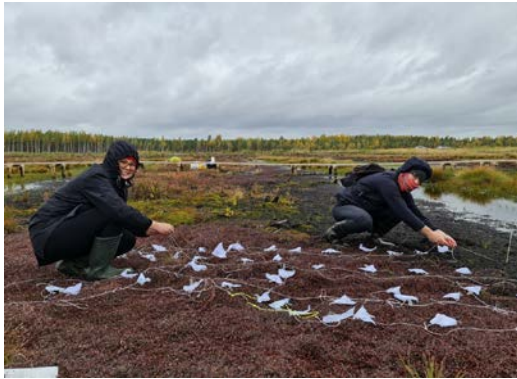
Joonis 14. Lagunemiskatse rajamine Ess-soos uurimisalal 2022. aastal. Vasakpoolsel joonisel proovide paigaldamine alale nr. 11 (kood C) pinnaspaisudega suletud kraavidega alal ning parempoolsel joonisel proovide paigaldamine suletud kuivenduskraavidega rabametsa alal.
