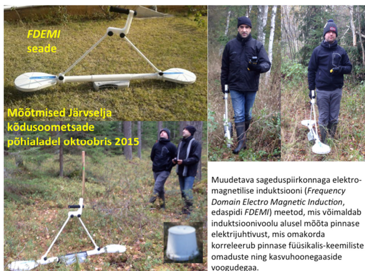
Joonis 7. FDEMI meetod kasvuhoonegaaside (KHG) voogude kiireks suurepindalaliseks määramiseks. Turbamuldade ning atmosfääri vaheliste KHG voogudega seostatakse FDEMI abil mõõdetud elektrijuhtivust teadaolevalt esmakordselt.
