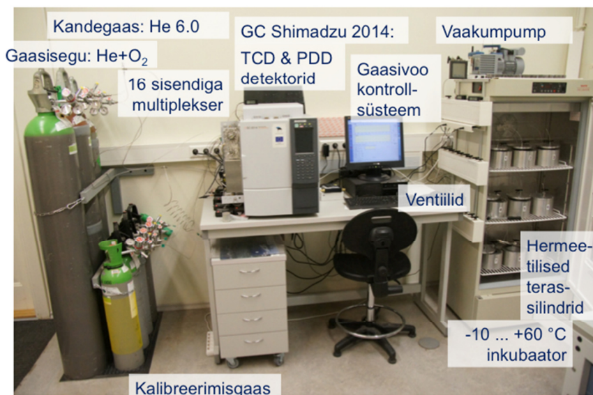
Joonis 6. He-O 2 meetodi baasil mullaproovides N 2 emissiooni mõõtmise süsteem.
