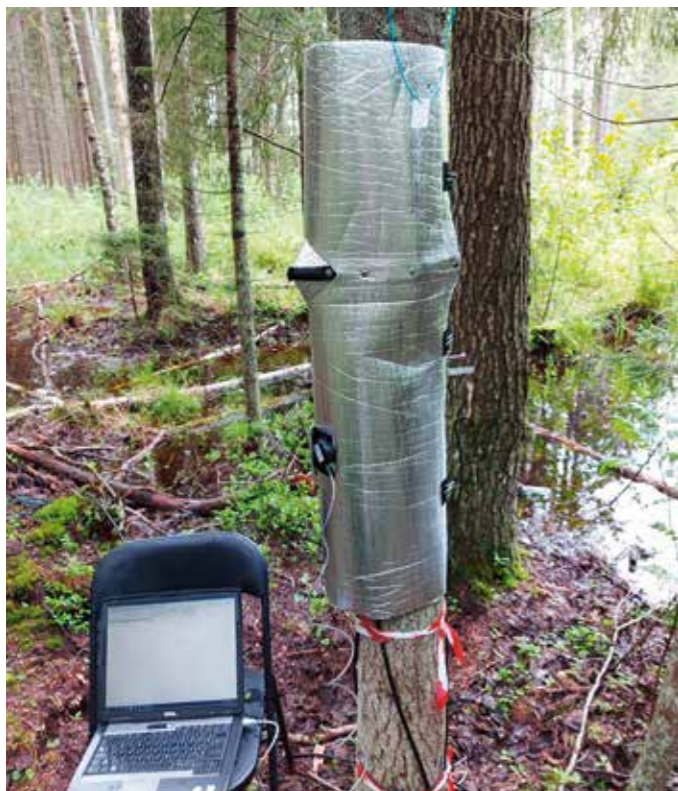
Foto 4. Puutüvele paigaldatud veevoolu andur mõõdab, kui palju vett läbi puu aja jooksul liigub. Andurid on kaetud fooliumkattega otsese päikesekiirguse vastu, et vältida päikeselaikest tingitud temperatuurigradiende, mis võivad mõõtmistulemusi mõjutada. Tegemist on kevaditi liigniiske angervaksa kasvukohatüübiga (lehtpuu enamusega puistu). Foto: Priit Kupper
