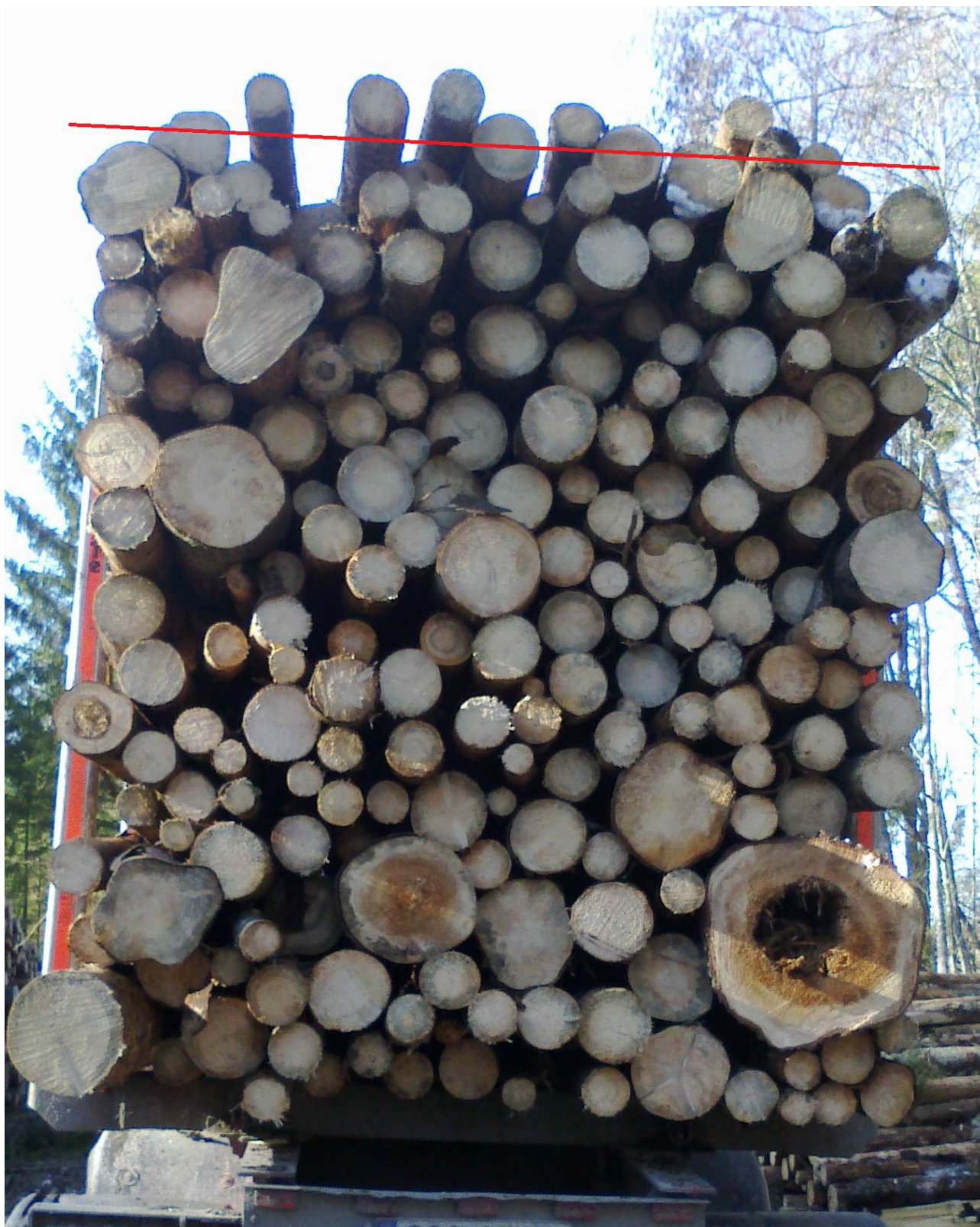
Joonis 4. Koormapakk, kus peab arvestama, et servad on madalamad, kui paki keskosa.
