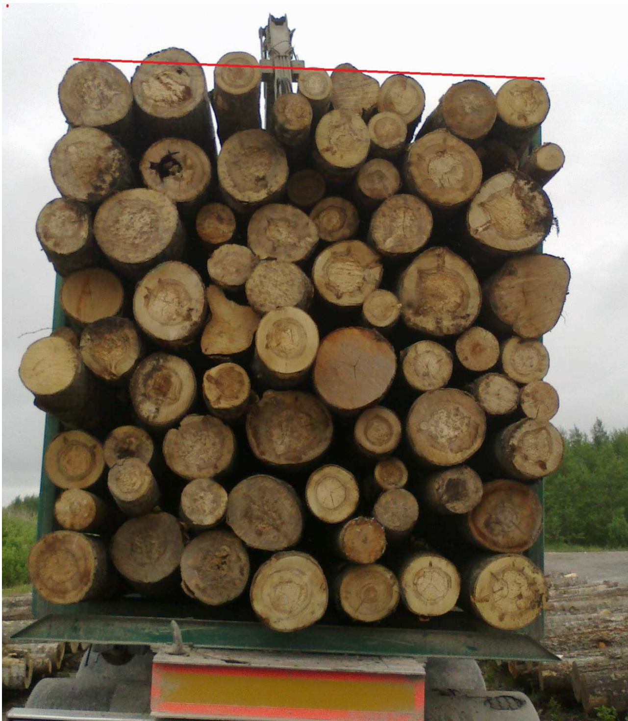
Joonis 3. Ühtlaselt laotud koormapakk, kus servade kõrgus mõlemal küljel võrdne.
